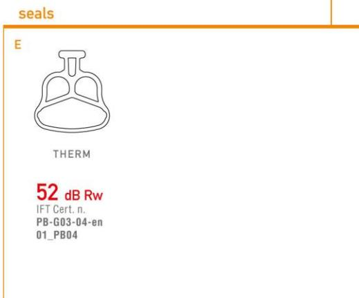
**IT** Solido e resistente, certificato per 52dB di abbattimento acustico da IFT di Rosenheim, grazie alla sua ampia guarnizione a tripla camera. È dotato di un doppio pulsante, metallico con regolazione a cacciavite su un lato ed inclinato in materiale plastico sull'altro, per una pressione ottimale della guarnizione sul pavimento ed una grande tenuta acustica.
